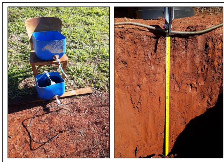
Figura 4. Ensaio para formação de bulbo molhado em um Nitossolo Vermelho eutroférico Latossólico com aplicação de água a 0,20 m de profundidade.
