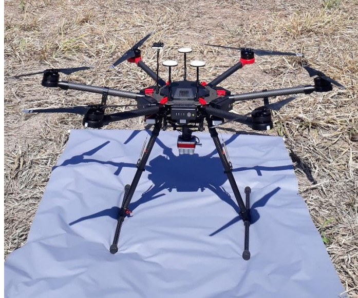
Figura 1. Veículo aéreo não tripulado, modelo Matrice 600 Pro da DJI®, embarcado com uma câmera Altum da Micasense.
