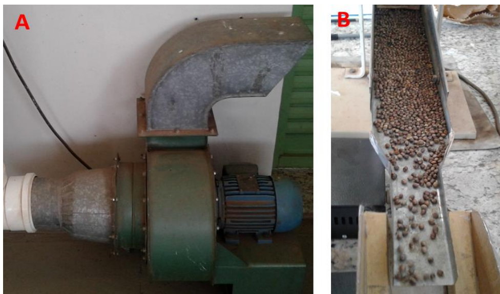
Figura 25: Exaustor e sementes. A: exaustor que forma o fluxo de vento. B: exemplo de sementes sendo encaminhadas ao fluxo de vento. Fonte: Arquivo pessoal. Foto: Júlia Barbosa de Paiva
