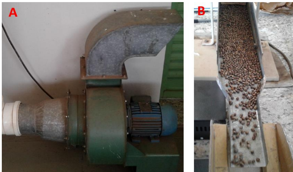
Figura 10: Exaustor e sementes. A: exaustor que forma o fluxo de vento. B: exemplo de sementes sendo encaminhadas ao fluxo de vento. Fonte: Arquivo pessoal. Foto: Júlia Barbosa de Paiva
