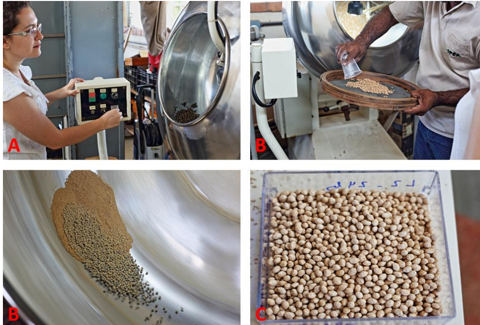
Figura 11: Processo de peletização. A: Sementes colocadas na betoneira com materiais do pélete. B: Sementes retiradas da betoneira e indo para secagem. C: Detalhe das sementes no interior da betoneira. D: Sementes peletizadas. Fonte: Arquivo pessoal da autora. Foto: Fabiano Turini Farah e Júlia Barbosa de Paiva
