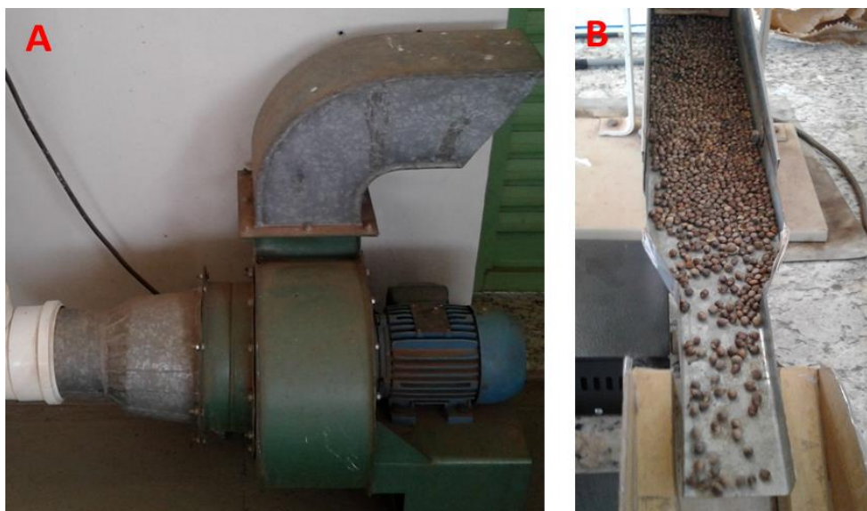
Figura 2: Exaustor e sementes. A: exaustor que forma o fluxo de vento. B: exemplo de sementes sendo encaminhadas ao fluxo de vento. Fonte: Arquivo pessoal. Foto: Júlia Barbosa de Paiva
