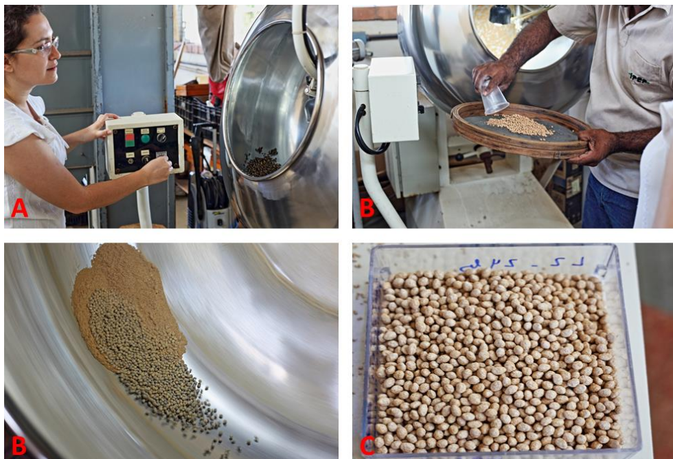
Figura 26: Processo de peletização. A: Sementes colocadas na betoneira com materiais do pélete. B: Sementes retiradas da betoneira e indo para secagem. C: Detalhe das sementes no interior da betoneira. D: Sementes peletizadas. Fonte: Arquivo pessoal da autora. Foto: Fabiano Turini Farah e Júlia Barbosa de Paiva
