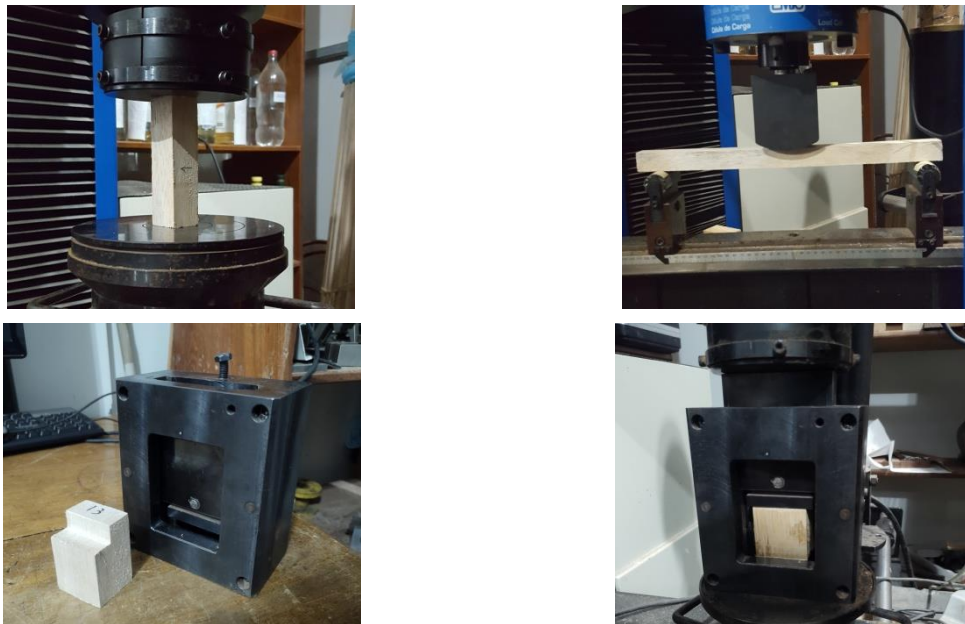
Figura 7. Ensaio mecânico de compressão paralela, flexão estática e cisalhamento realizados na máquina de ensaios universal
