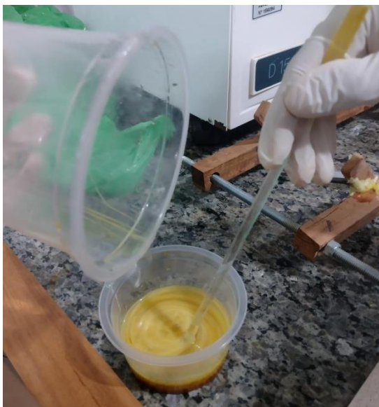
Figura 10. Mistura dos dois componentes do adesivo.
