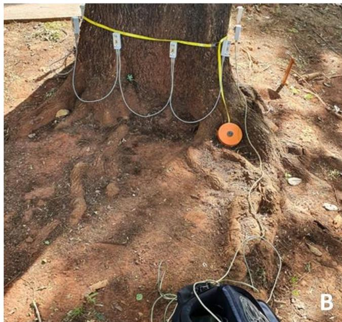
**Figura 35. A:** Árvore da espécie freixo (*Fraxinus excelsior*), com diâmetro basal de 110,14 cm, localizada na Área de Lazer da Rua do Porto em Piracicaba-SP, que forneceu amostras de madeira e recebeu tomografia de tronco e raízes com Arbotom e Arboradix. **B:** Freixo (*Fraxinus excelsior*) com sensores do Arbotom posicionados em seu colo e afloramento de algumas de suas raízes de ancoragem.
