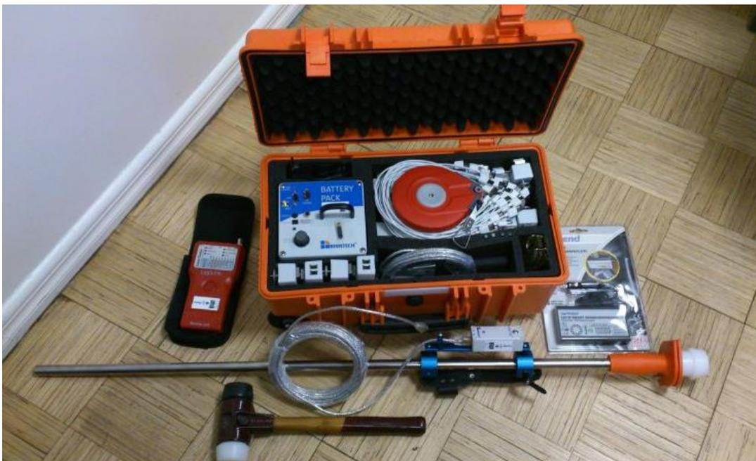
**Figura 11.** Equipamento completo de tomografia de tronco e raízes: Arbotom® e Arboradix™ ambos Rinntech. Fonte: [3]
