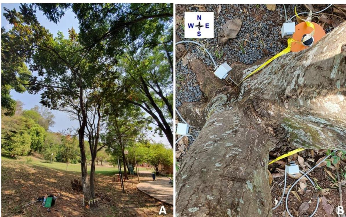
**Figura 32. A:** Árvore da espécie espatódea (*Spathodea campanulata*), com diâmetro basal de 46,79 cm, localizada na Área de Lazer da Rua do Porto em Piracicaba - SP, que forneceu amostras de madeira e recebeu tomografia de tronco e raízes com Arbotom e Arboradix. **B:** Detalhe dos troncos codominantes da espatódea (*Spathodea campanulata*) durante tomografia de seu colo com Arbotom.
