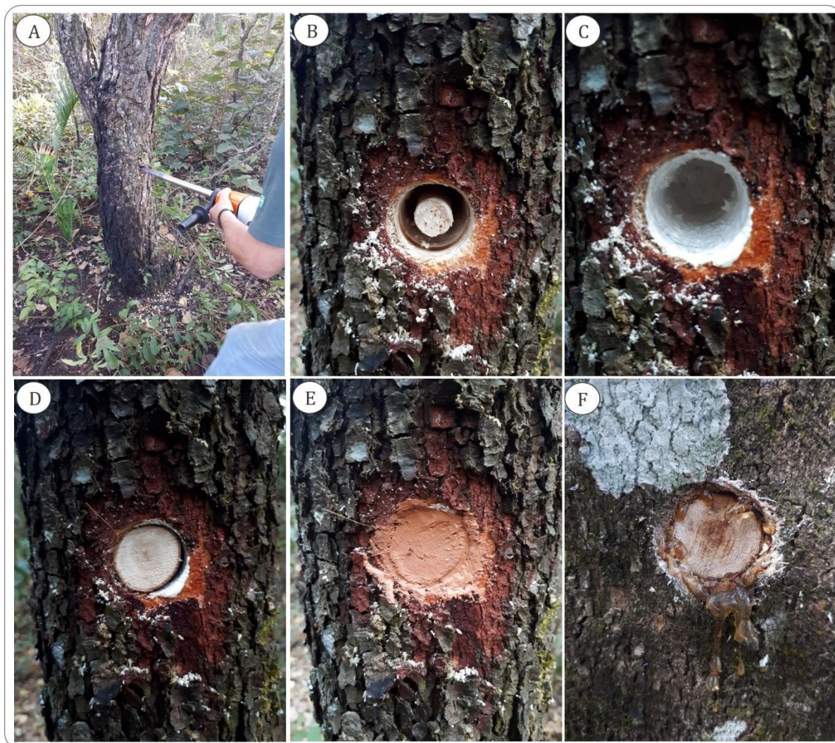
Figura 13. Procedimento de coleta das amostras de madeira com o uso do extrator motorizado ( C. langsdorffii ): (A) Perfuração do tronco da árvore; (B) Amostra presa à árvore após perfuração; (C) Tratamento do orifício com cupinicida e tinta antifúngica; (D) Fechamento do orifício com madeira de mesmo calibre, com nova aplicação de cupinicida na superfície; (E) Aplicação de massa para vedação; (F) Exemplo de vedação natural promovida pela árvore após o preenchimento do orifício com madeira de igual calibre logo após a coleta ( V. tucanorum ).
