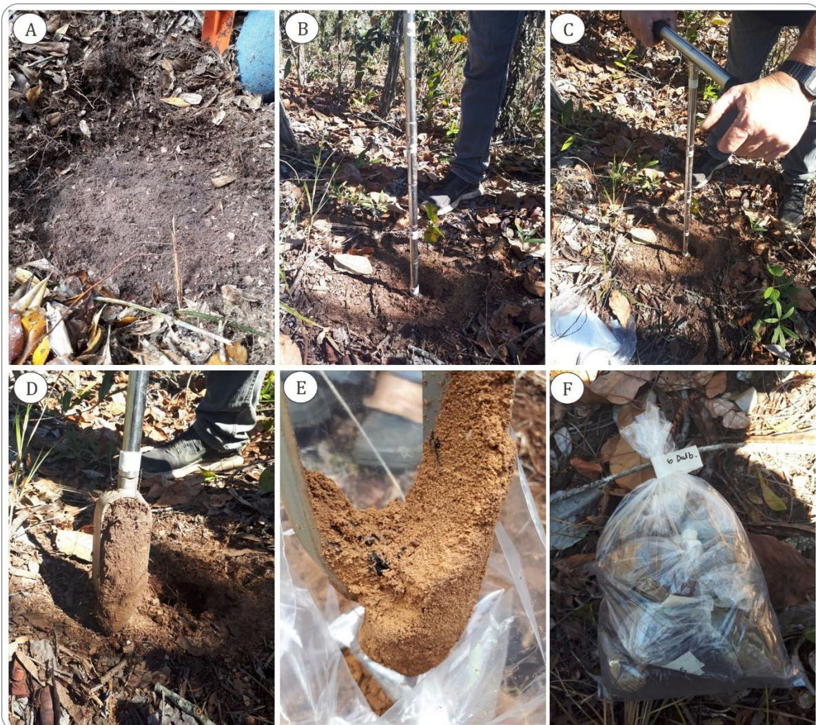
Figura 14. Procedimento de coleta de solo com trado holandês nas profundidades 0-5 cm, 5-25 cm, 40-60 cm e 80-100 cm: (A) Limpeza superficial (remoção das folhas); (B, C) Introdução do trado até as marcações referentes às diferentes profundidades de coleta; (D) Solo aderido ao trado; (E) Presença de carvão em profundidade observada em Jaguariaíva-PR; (F) Acondicionamento em sacos plásticos identificados.
