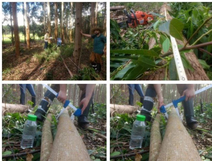
Figura 2.4: Procedimento de cubagem rigorosa estabelecendo as duas medidas perpendiculares nas alturas das seções pré-definidas, por meio de suta graduada e trena para sinalização das seções. Em alguns momentos, marcas em giz foram utilizadas para facilitar a localização das seções, bem como o diâmetro mínimo.
