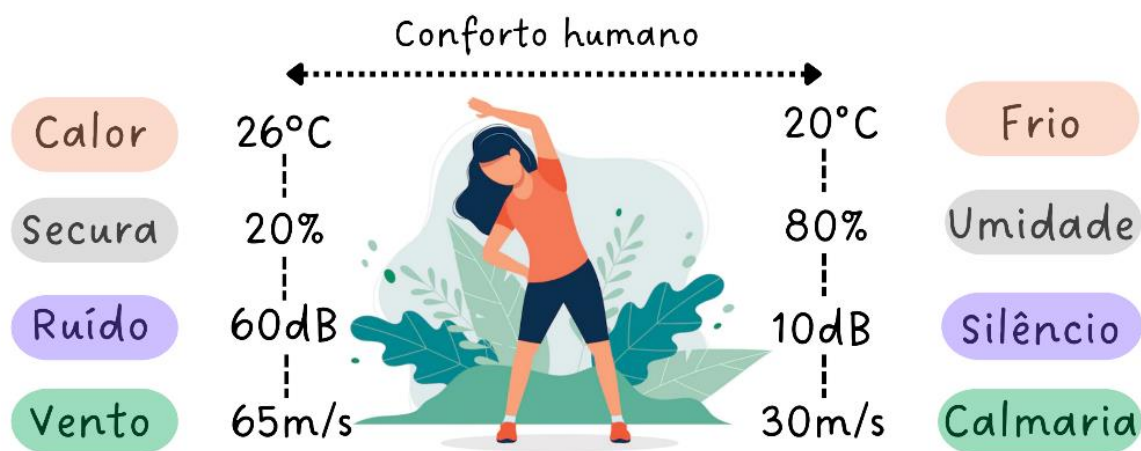
Figura 2. Zonas de tolerância em relação ao conforto humano, para temperatura (°C), umidade (%), sonoridade (Db) e velocidade do vento (m/s). Fonte: Houseal e Brian (1979).
