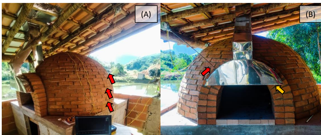
Figura 6. Vista lateral do forno, mostrando os três termopares laterais – 1, 2 e 3, de baixo para cima, respectivamente (A), vista frontal do forno, mostrando o termopar posicionado próximo à saída dos gases, que ocorre na coifa (seta laranja e preto) acoplada na porta do forno (B), os termopares são indicados pelas setas em vermelho e preto
