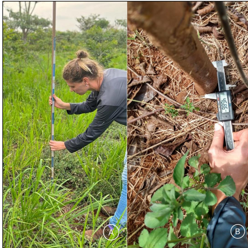
Figura 5. Avaliações realizadas no experimento. (A) Medição da altura total com auxílio de haste de bambu acoplada com fita métrica de 1,50 m. (B) Medição do diâmetro à altura do solo com paquímetro digital. (C) Drone utilizado para capturar as imagens de voo para cobertura de copa. Fotos: da autora.
