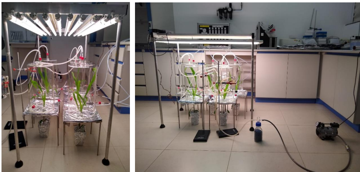
Figura 5. Sistema utilizado para a coleta dos compostos orgânicos voláteis dos genótipos de milho, por meio de cubas de vidro conectadas ao sistema ARS Volatile Collection System.
