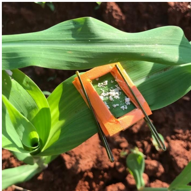
Figura 2. Estrutura confeccionada em EVA e fixada na planta com objetivo de re coletar a mistura contendo microescleródios para análise em estereomicroscópio.
