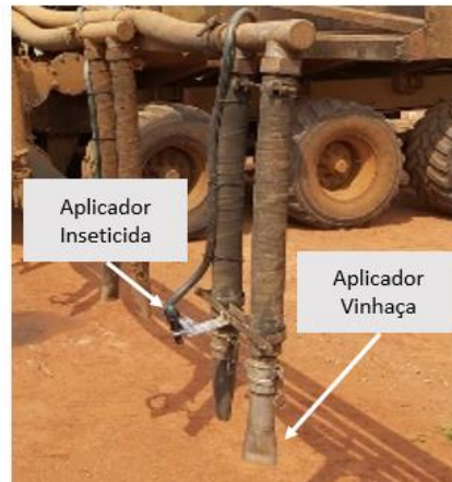
Figura 10. Detalhe da ponta pulverizadora para aplicação de inseticida sobre a linha da cana, simultaneamente à aplicação de vinhaça localizada.
