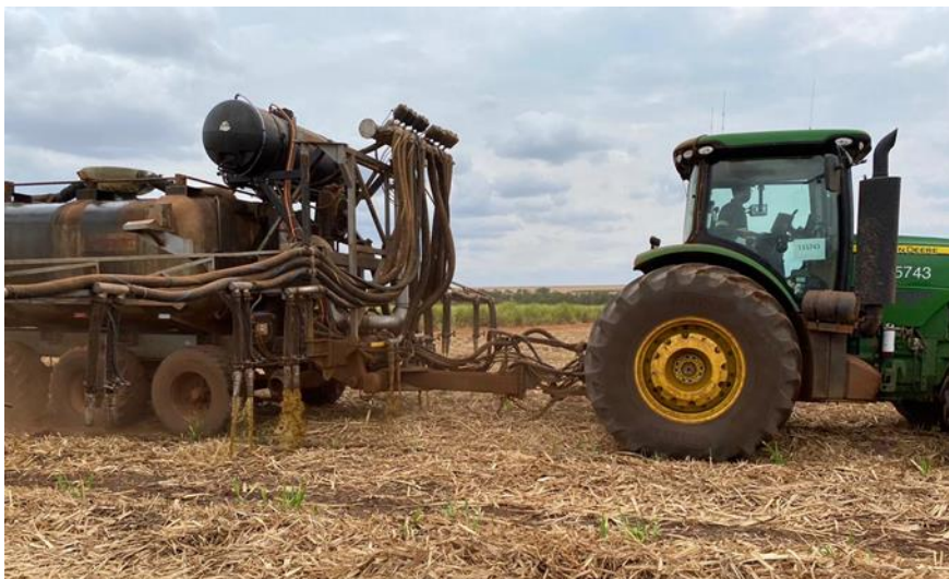
Figura 9. Conjunto trator/implemento aplicador de vinhaça localizada com acoplamento de tanque “inseticida” na parte superior.
