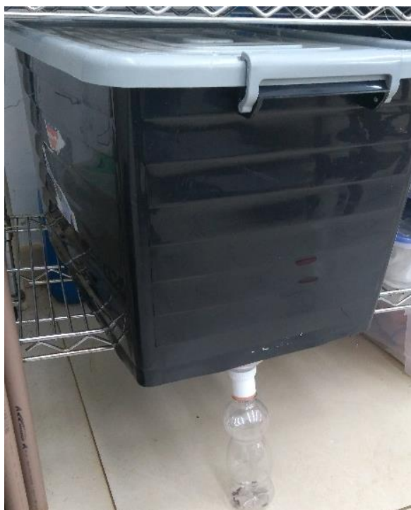
Figura 2: Câmara de emergência utilizada para o monitoramento de Dinoderus minutus , em telhas de bambu infestadas. A caixa é completamente selada e a única fonte de luz para o interior da câmara é pelo pote coletor
