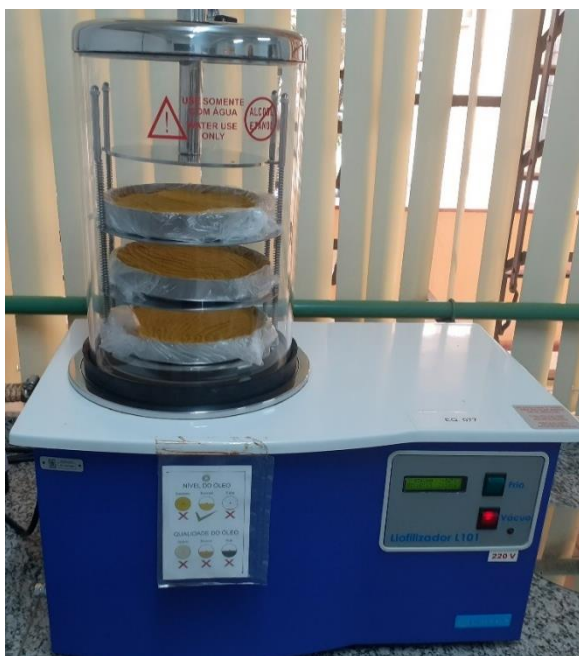
Figura 8. Liofilizador L101 - Liotop® de bancada com polpa de uvaia (Foto: Acervo Pessoal: Gabriela Mandro)
