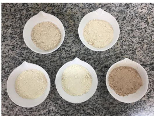
Figura 17 - Farelo de soja resultante da extração do óleo após evaporação do solvente
