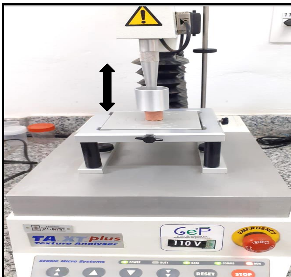
Figura 7 – Salsicha previamente cozida em água, recebendo compressão do texturômetro para análise do perfil de textura.
