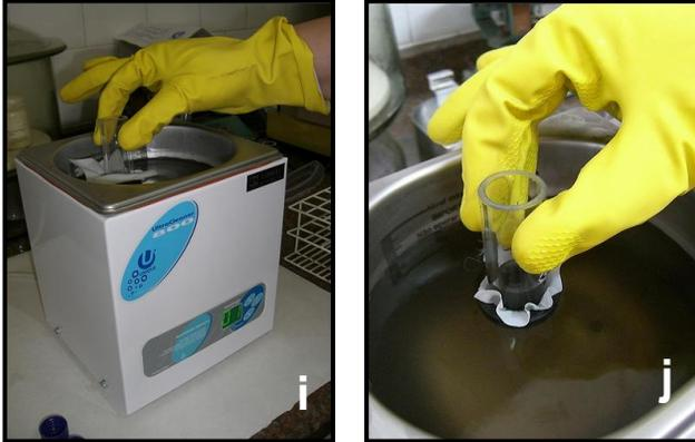
Transferência das amostras para tubos de acrílico montados com filtro de nylon com malha de 5  $\mu\text{m}$  para a tamisação das amostras em ultrassom durante 3 minutos. Utilização do sedimento retido.
