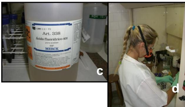
Adição de ácido fluorídrico (HF) a 40% para dissolução de silicatos. Repouso por 24 horas.
