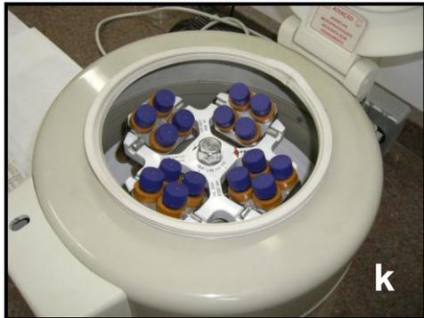
Adição de água glicerinada (1:1), centrifugação, descarte do sobrenadante e alocação dos tubos com a boca para baixo para escoamento total do líquido encerrando-se o tratamento das amostras.
