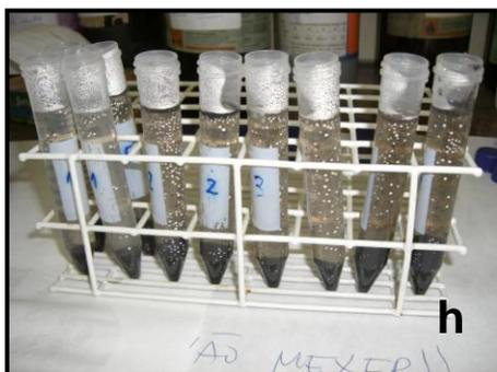
Adição de 5 ml de mistura de acetólise (4,5 ml de anidrido acético e 0,5 ml de ácido sulfúrico) para dissolução de parte da matéria orgânica e acetilação da exina dos grãos de pólen e esporos. Manutenção por 4 minutos em fervura no banho-maria.
