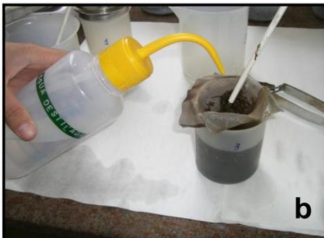
Retirada de restos vegetais, areia e outros materiais através da tamisação das amostras em peneira de malha de 250  $\mu\text{m}$ .
