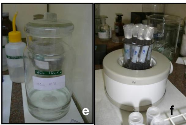
Adição de ácido clorídrico (HCl) a 10% e fervura para a eliminação dos fluossilicatos formados na reação anterior.
