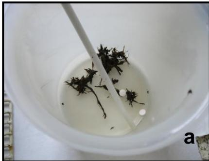
Introdução de 2 pastilhas de esporo marcador *Lycopodium* (cada uma com 12.542 esporos) (Batch nº 124961) e água destilada em cada béquer com a amostra de solo.
