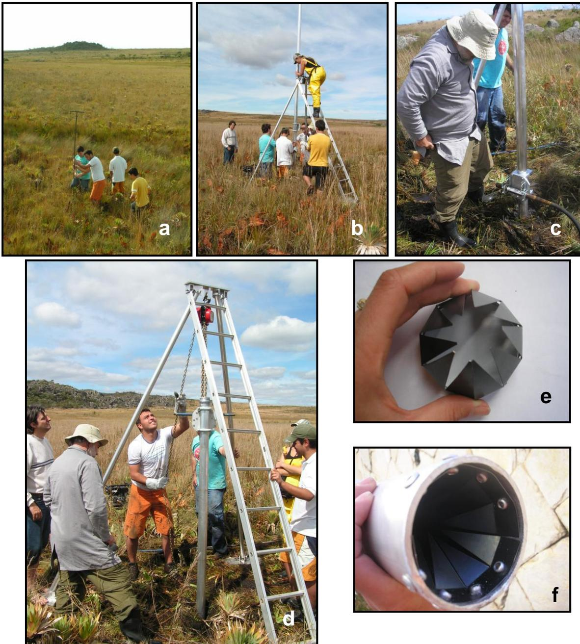
Figura 16 - (a) Escolha do ponto de amostragem do testemunho. (b) (c) (d) Amostragem do testemunho com uso do vibrotestemunhador. (e) (f) Aranhas do tubo de coleta
