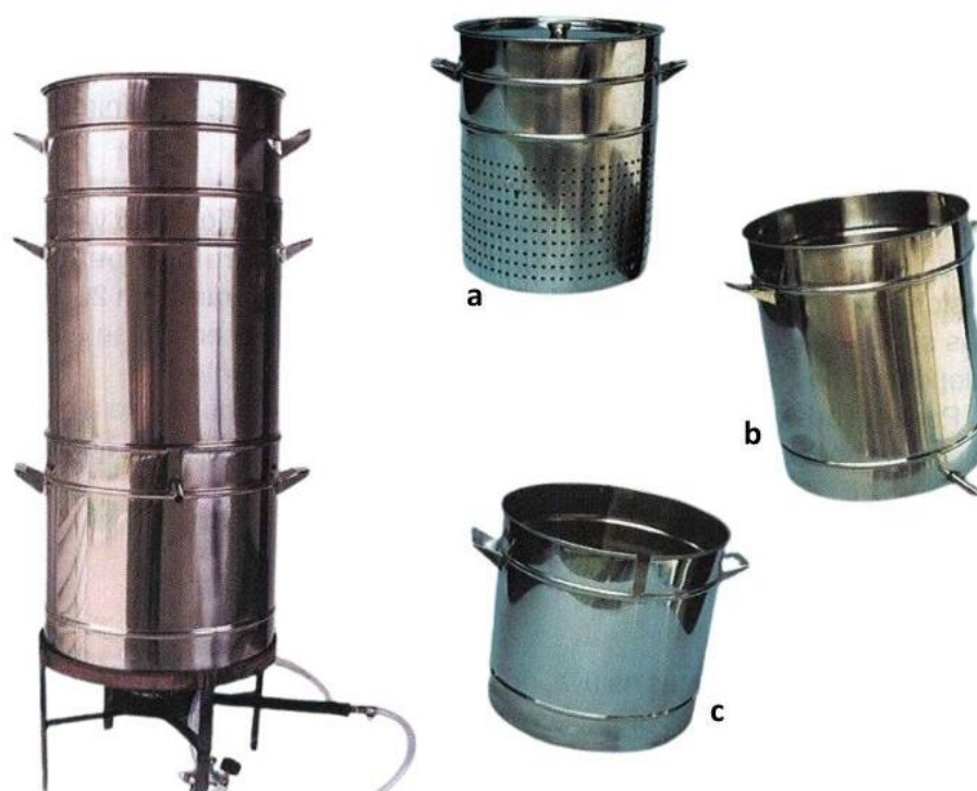
Figura 8. Imagem adaptada de Rizzon; Manfroi; Meneguzzo. (1998). Extrator a) recipiente com tampa para inserção da uva; b) recipiente do extrato; c) depósito de água.
