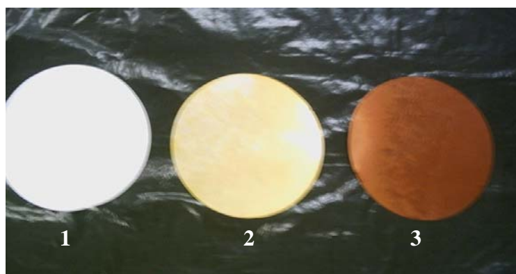
Figura 1 – Tiras impregnadas com óxidos de Fe. 1 = Papel filtro Whatman n. 50; 2 = Papel filtro após 2 h embebido em solução de \text{FeCl}_3 0,6 \text{ mol L}^{-1} ; 3 = Papel filtro após imersão em \text{NH}_4\text{OH} 2,7 \text{ mol L}^{-1} por 45 s
