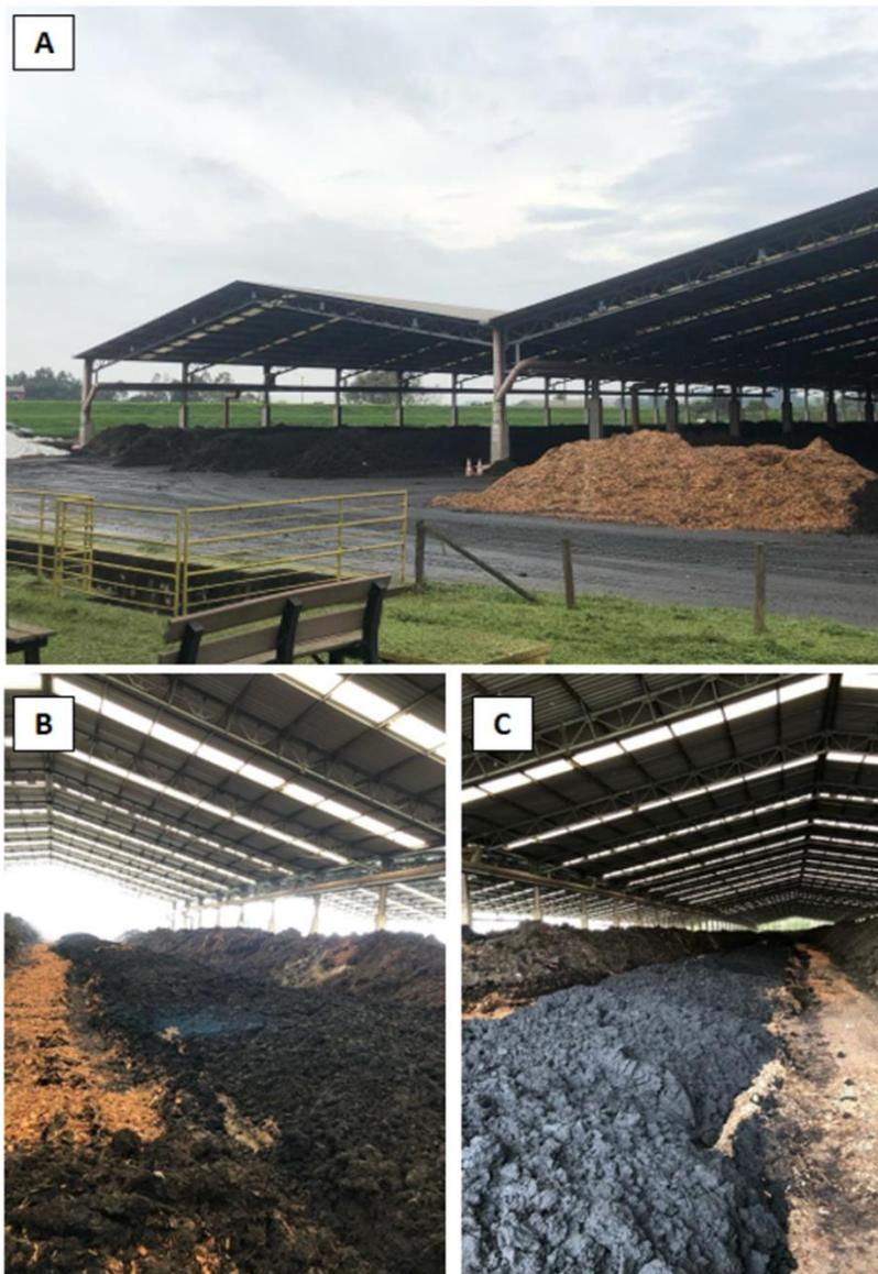
**Figura 1:** Estrutura da Unidade de Gerenciamento de Lodos (UGL) - Jundiaí, São Paulo, para realização da compostagem termofílica do lodo de esgoto em escada industrial, sendo: A) galpão de compostagem; B) leira de compostagem e; C) matéria prima para compostagem (lodo de esgoto fresco).
