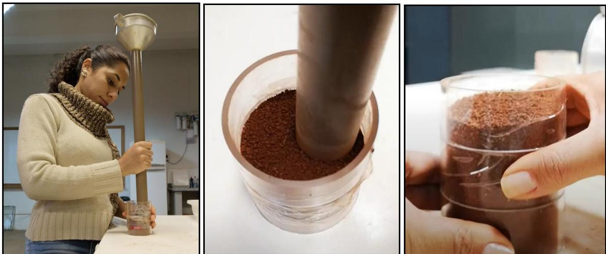
Figura 19. Acondicionamento da *TFSA* nos anéis acrílicos.
