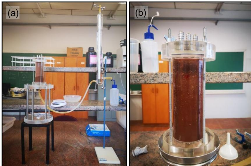
**Figura 25.** Início da saturação da coluna de solo (a) e coluna de solo completamente saturada (b).
