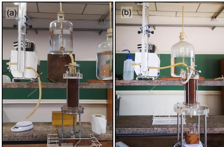
**Figura 26.** Lavagem da coluna de solo (a) e colocação do pulso de KCl e passagem do pulso de KCl através da coluna de solo (b).
