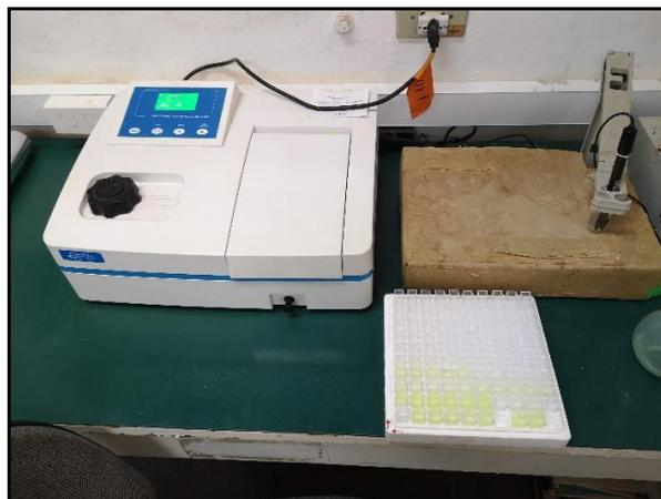
**Figura 13.** Leitura da fosfatase ácida e da β-glucosidase em espectrofotômetro, a 410 nm.
