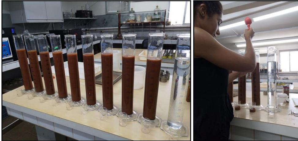
**Figura 8.** Análise granulométrica pelo método da pipeta.
