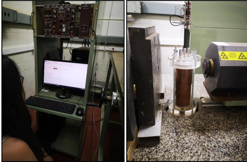
**Figura 24.** Determinação da  $\rho$  por atenuação de radiação gama.
