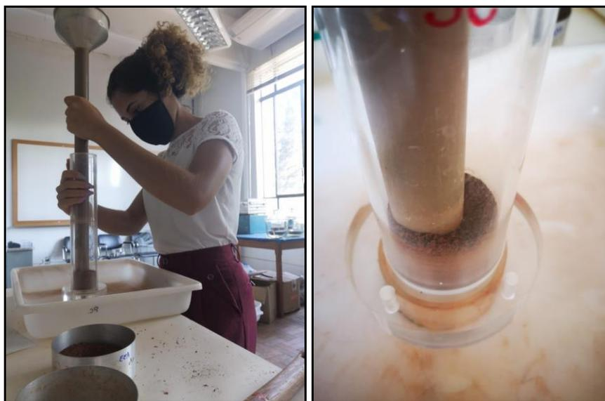
**Figura 23.** Acondicionamento do solo dentro das colunas de acrílico.
