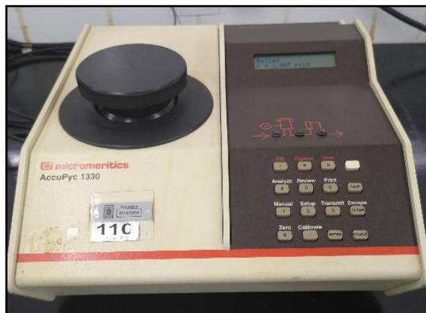
**Figura 11.** Picnometro da Micromeritics, modelo AccuPyc 1330.
