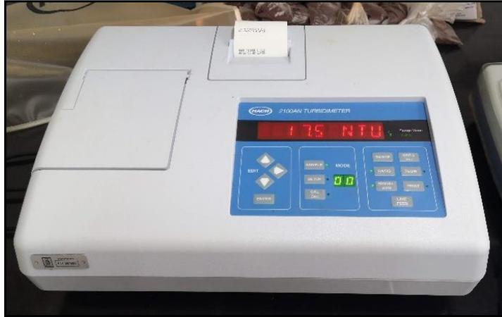
**Figura 17.** Turbidímetro modelo HACH 2100AN.
