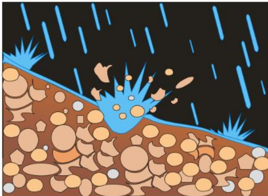
Figura 1. Efeito “Splash”. Início do processo erosivo e causador do selamento superficial (Fonte: CARDOSO & CAMPOS, 2009, adaptado de GUERRA, 1998).
