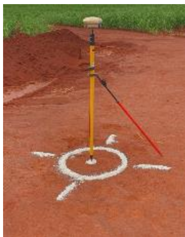
Figura 8. Equipamento R6, da marca Trimble®, que realiza o georreferenciamento com correção Real Time Kinematic (RTK), utilizado para a validação dos pontos de controle da área em estudo.
