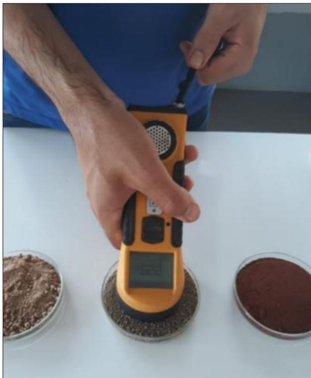
**Figura 2.** – Determinação da suscetibilidade magnética (SM) em subamostras de solo.
