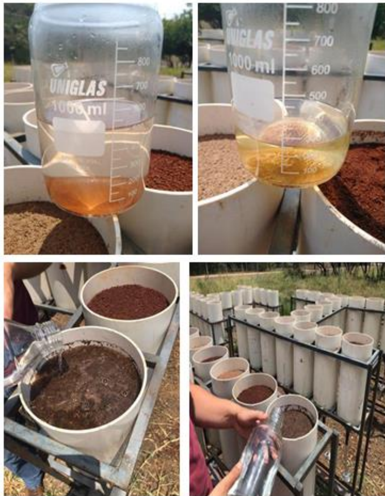
Figura 6: Checagem do funcionamento dos lisímetros antes do início do experimento.
