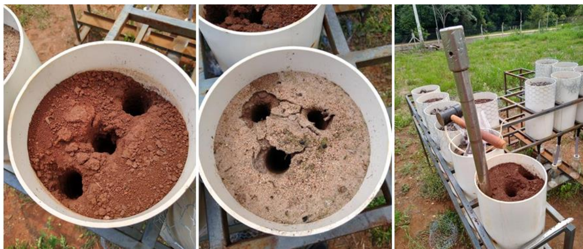
Figura 8: Amostragem de solos dos lisímetros nas camadas 0-10c, 10-20cm e 20-30cm durante o período experimental.
