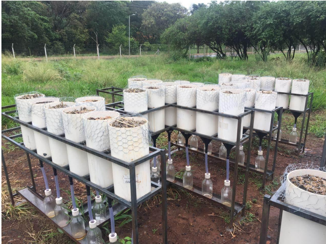
Figura 7: Experimento montado já com as telas de segurança para evitar perda de restos vegetais e com recipientes coletores de lixiviados.
