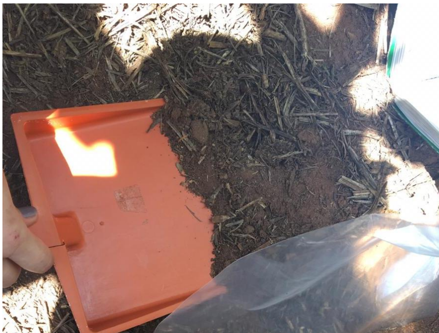
Figura 3. Metodologia empregada para a coleta de solo de 0,01m em campo, com a utilização de uma pá.
