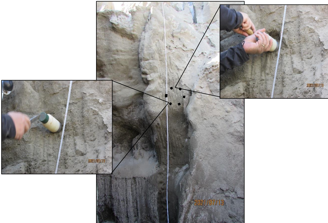
Figura 4. Coleta de amostra indeformada para densidade na parede de erosão.
