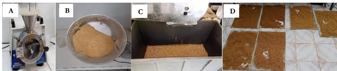
Figura 6. Processos para produção das rações experimentais extrudadas para tilápias do Nilo sendo (A) Moinho de ingredientes; (B) Misturador de ingredientes; (C) Processo de extrusão da ração; (D) Ração armazenada em bandejas metálicas para secagem e pronta para alimentação dos peixes.
