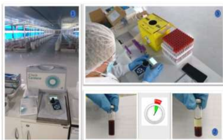
Figura 3 – (1) Equipamento portátil iCheck Carotene; (2) Análise no equipamento; (3) Kit de extração dos carotenoides.
