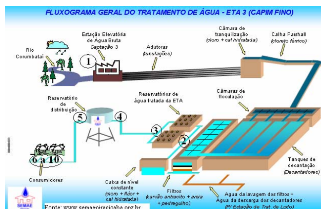
Figura 2 – Pontos amostrados no ETA 3 e na rede de distribuição, sendo (1) Captação de água; (2) Entrada dos reservatórios no ETA 3; (3) Saída dos reservatórios do ETA 3; (4) Entrada do reservatório de distribuição; (5) Saída do reservatório de distribuição; (6 a 10) Amostragens nos pontos de consumo (residências)
