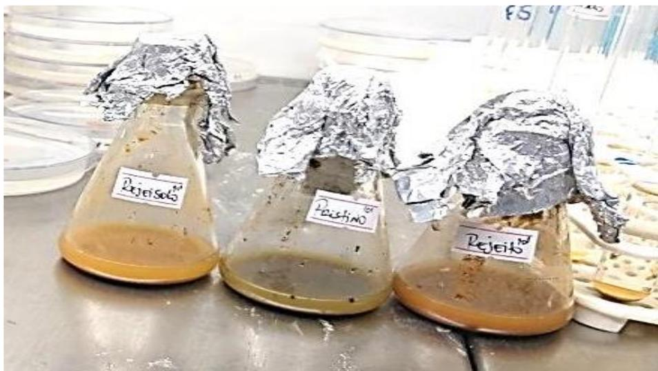
Figura 4 – Amostras de sedimento e rejeito agregado (RES); Sedimento sem contaminação (PRIS); Rejeito (REJ)
