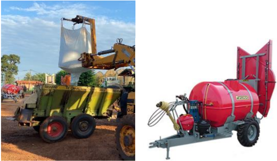
Figura 6. Adubadeira Kamaq Komander 60, utilizada para aplicação de fertilizantes no solo (esq.) e Turbo atomizador Natali Alfa 4000 – Citrus (Fonte: Autor e Natali Agrícola).
