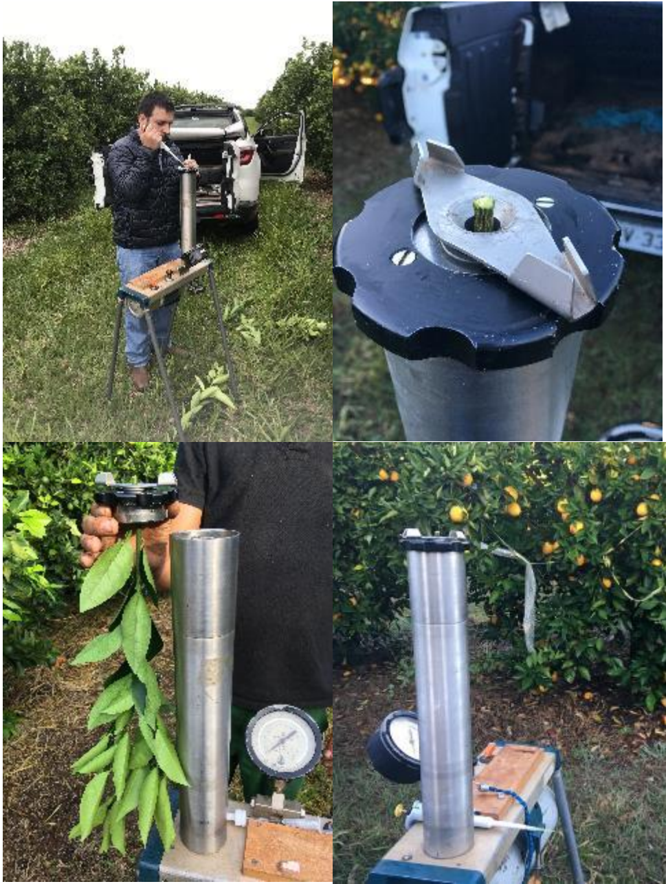
Figura 9. Preparo da câmara de Scholander com o ramo de laranjeira para extração de seiva.
