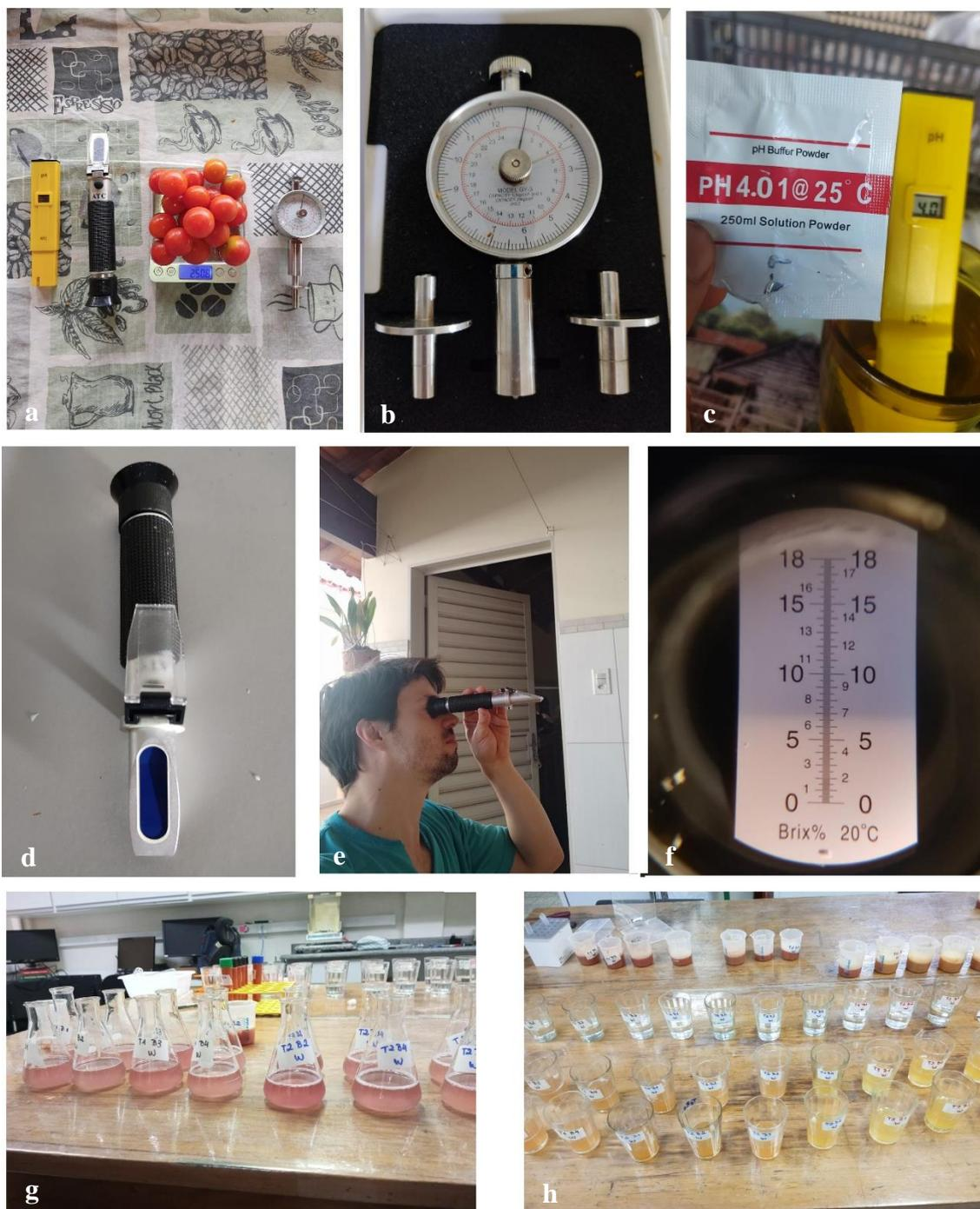
**Figura 19.** Análise de qualidade: **a)** Equipamentos utilizados na análise de qualidade de tomate *in natura*, pHmetro, refratômetro, balança de precisão e penetrômetro, **b)** Penetrômetro **c)** Calibração ácida do pHmetro, **d)** Refratômetro, **e)** Procedimento de leitura de uma refratômetro, **f)** Leitura do Refratômetro de uma análise, **g, h)** Análise de qualidade realizada na ESALQ, preparo das amostras para as leituras.
