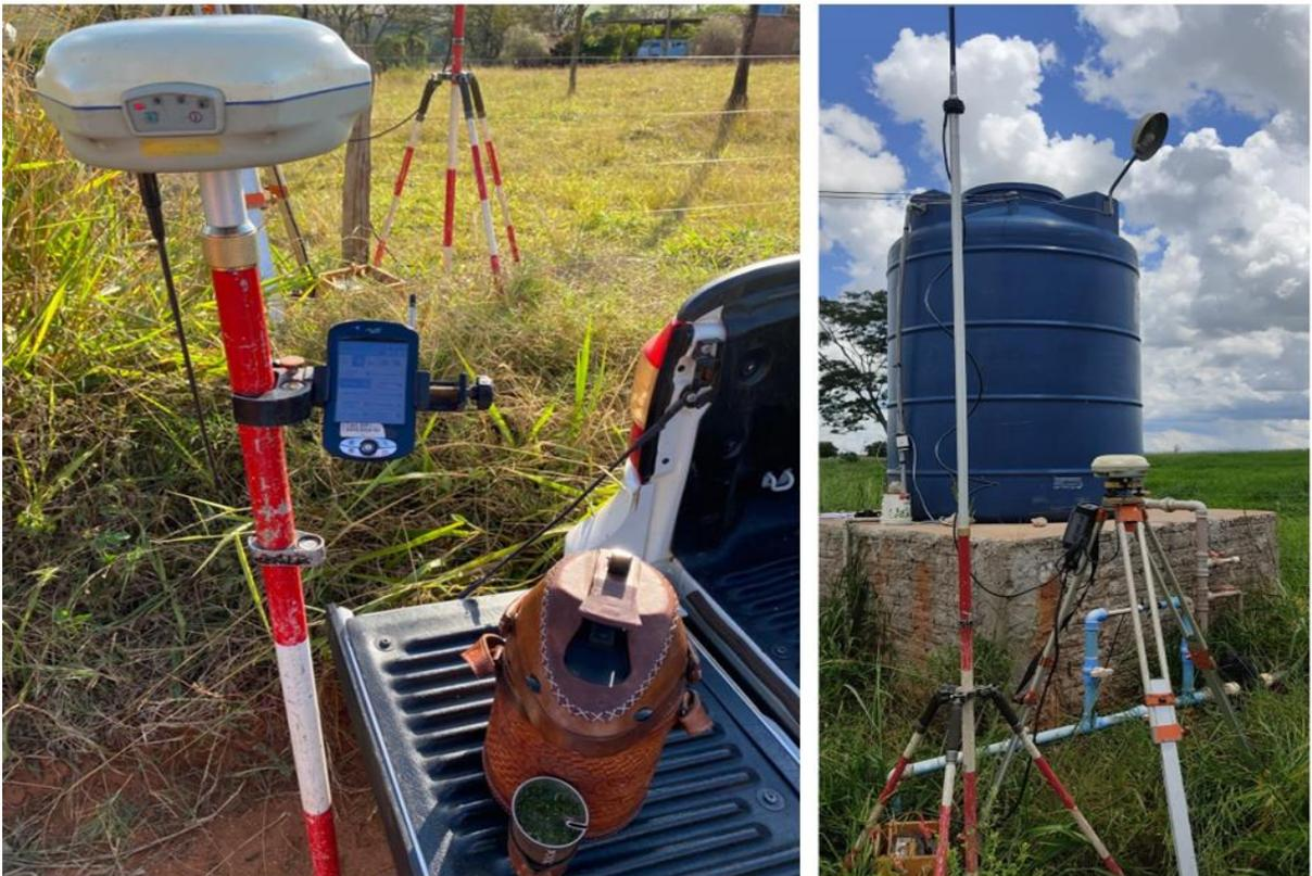
**Figura 20.** Aparelho de GPS Geodésico utilizado no georreferenciamento das plantas.
