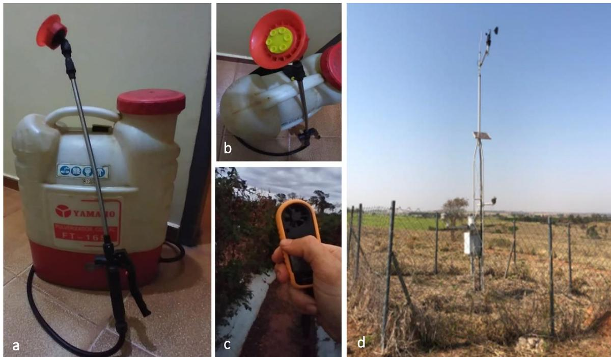
**Figura 16.** a) Pulverizador utilizado nas aplicações dos inseticidas testados, b) Detalhe do bico regador de 6 saídas, c) Medição da velocidade do vento utilizando um anemômetro, d) Estação Meteorológica Estadual de General Salgado.
