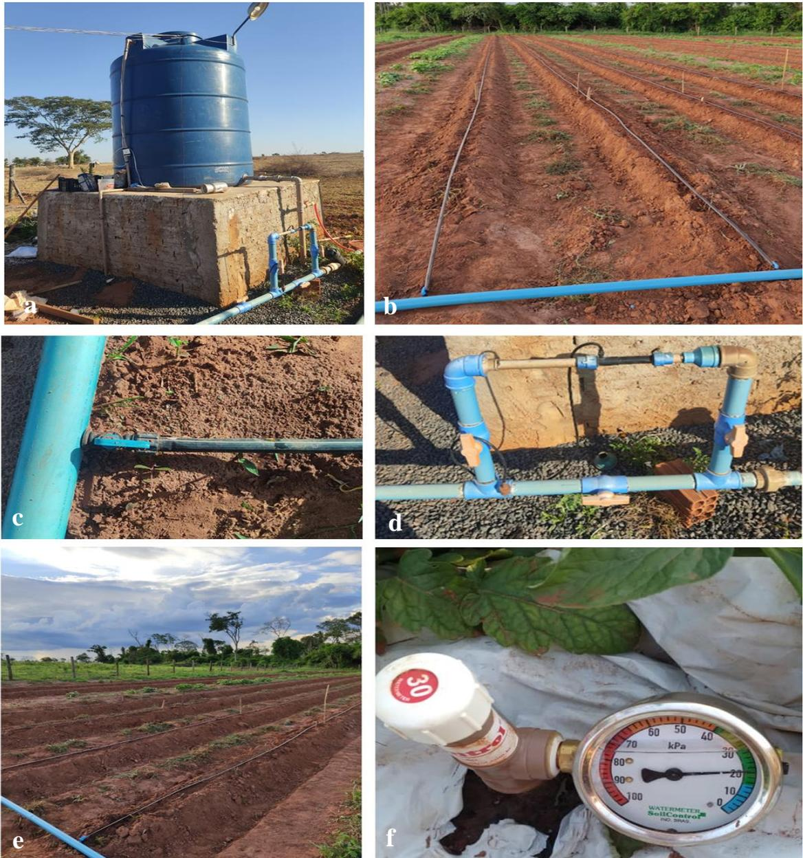
**Figura 12.** Sistema de Irrigação do experimento: **a)** Reservatório para armazenagem da água, **b), e)** Tubos de 2" e fitas de gotejamento **c)** Registro inicial da fita gotejadora **d)** Sistema Venturi para fertirrigação, **f)** Tensiômetro utilizado para o monitoramento da irrigação.
