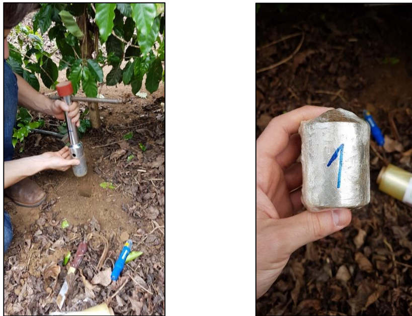
Figura 4. Sonda utilizada para amostra indeformada de solo e amostra em anel volumétrico.
