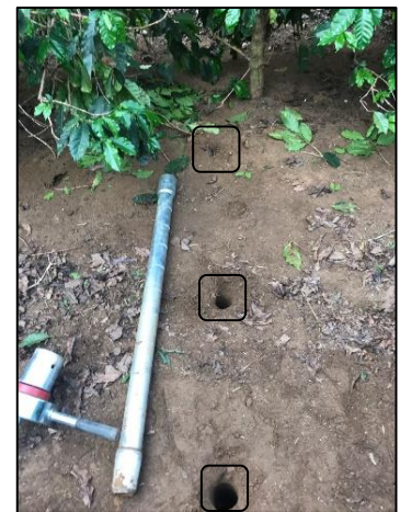
Figura 3. Posições de coleta de solo (P1, P2 e P3) em relação à linha de café. P1, sob a copa; P2, rodado do trator; P3, entrelinha de café, nos dois sistemas de cultivo. A direita detalhe das posições P1, P2 e P3 in loco.
