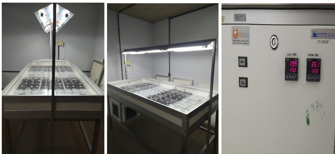
Figura 1. Mesa termogradiente: testes de germinação das sementes de Apeiba tibourbou e Guazuma ulmifolia , variações de temperatura entre 20°C e 35°C.
