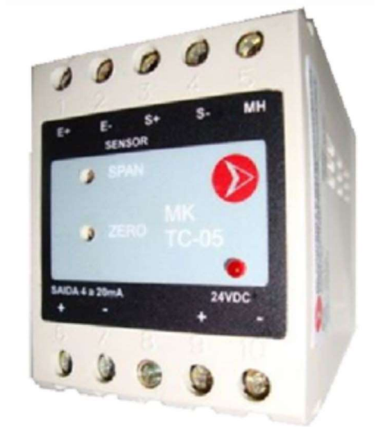
Figura 10 - Amplificador MKTC-05 da MK controle e Instrumentação.
