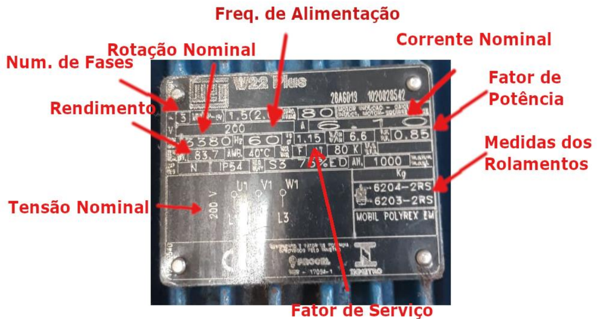
Figura 9: Placa de identificação do motor da esteira Moviment® LX160 (motor Weg W22 plus de 2 cv)
