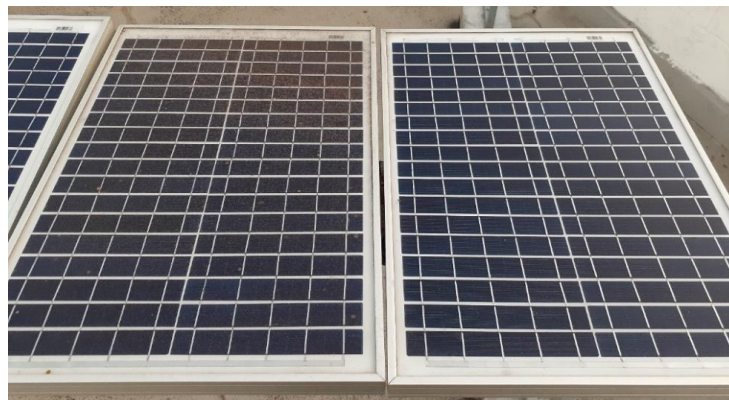
Figura 3.17 – Módulos padrão Sujo x Limpo
