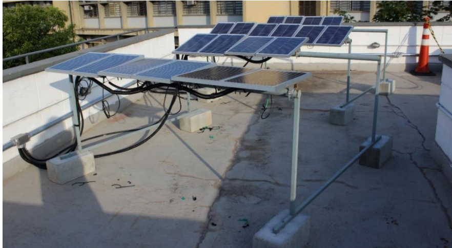
Figura 3.16 – Módulos calibrados e alocados nos ângulos definidos em projeto
