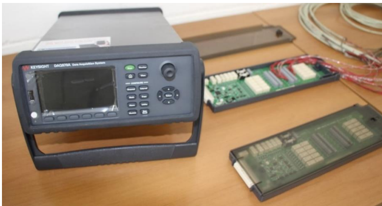
Figura 3.13 – Datalogger da marca Keysight modelo DAQ970A e as placas de aquisição de dados
