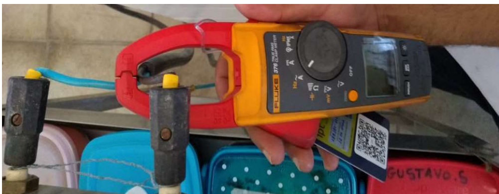
Figura 7 – Medidor Fluke 376 True RMs Clamp Meter utilizado na pesquisa
