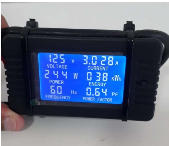
Figura 6 – Medidor Peacefair, modelo PZEM-022 utilizado na pesquisa.
