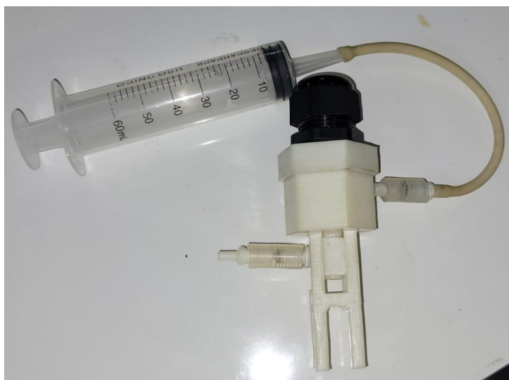
Figura 19 – Invólucro do oxímetro impresso em 3D
