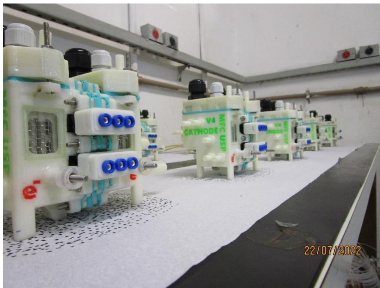
Figura 16 – CCM's durante o teste de estanqueidade
