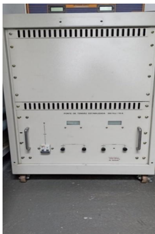
Figura 3.14 – Fonte de tensão estabilizada 500 Vcc/10 A da Tectrol .
