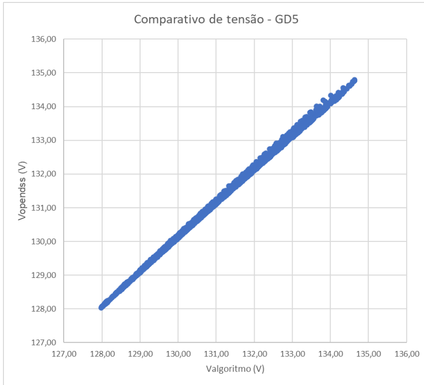
Figura 6.9 – Respostas dos valores de tensão da barra 5 para o algoritmo desenvolvido e para o programa OpenDSS, em simulações com menores comprimentos de rede.
