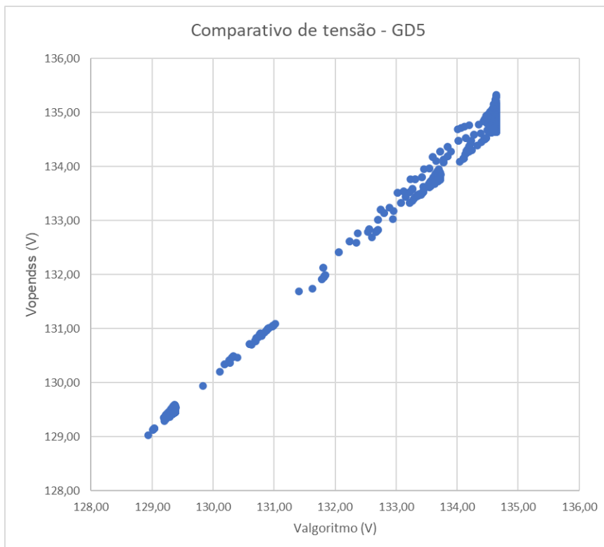
Figura 6.4 – Respostas dos valores de tensão da barra 4 para o algoritmo desenvolvido e para o programa OpenDSS.
