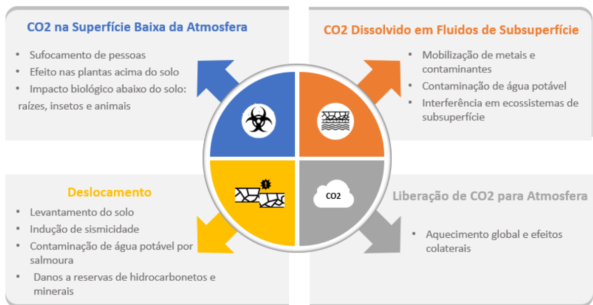
Figura 10 – Riscos de armazenamento geológico de CO 2
