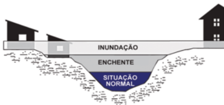
Figura 3 - Perfil esquemático dos processos de enchente e inundação
