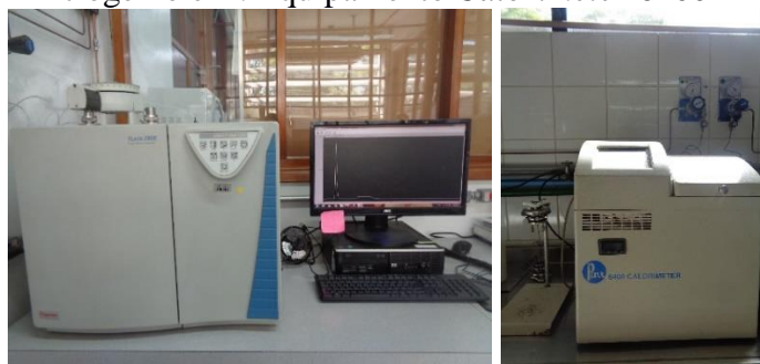
Figura 17 (A e B): A: Equipamento Flash 2000 - Analisador de carbono, hidrogênio e nitrogênio e B: Equipamento Calorimeter 6400
