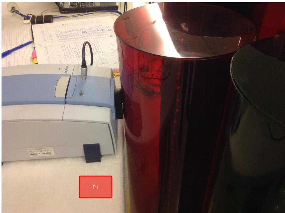
Figura 10 Fotografia da medição por espectroscopia infravermelha com transformada de Fourier (FTIR), utilizando o modo de reflexão externa, na obra “*Ci-da-da-ci-da-de-c*” (1969), de Érika Steinberger, Acervo MAC-USP, Foto: André Maragno/IFUSP, 2019.
