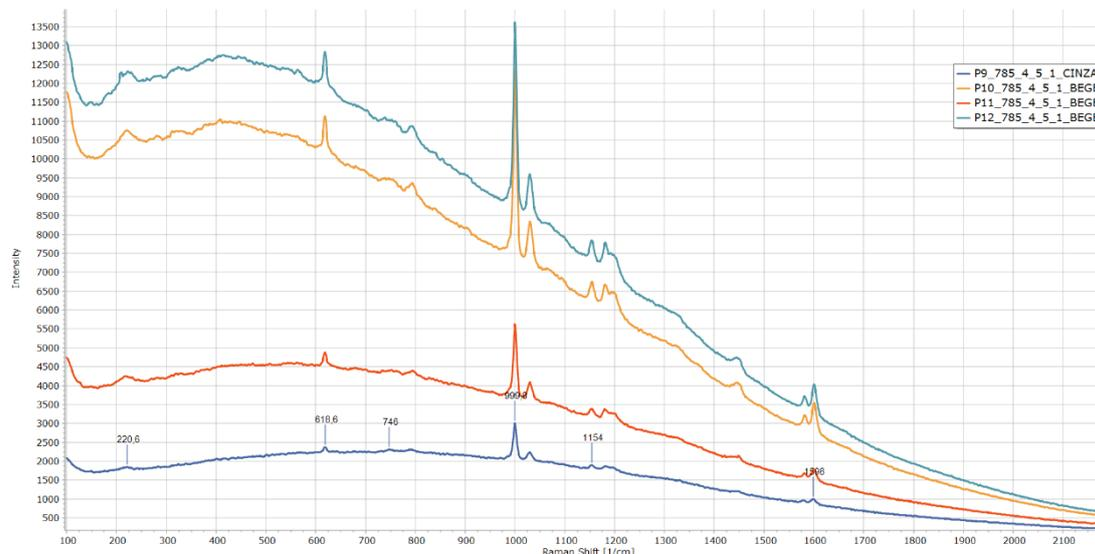
Figura 34 Análise de espectroscopia Raman, comparando espectros das cores cinza e bege.
