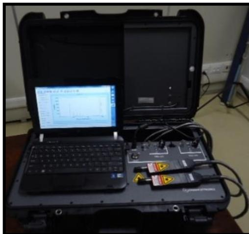
Figura 8 Sistema portátil de Espectroscopia Raman utilizado nas análises.
