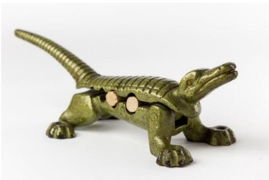
Jacaré. Modelador de rolhas que são utilizadas no fechamento e vedação de frascos de medicamentos em vidro. O formato de jacaré se deve ao poder de cura e de imortalidade que eram atribuídos a esse animal na Antiguidade. Equipamento em metal, revestido com tinta verde, datado das primeiras décadas do século XX. Centro de Documentação e Memória RD. Foto: Adriana Moreno.
