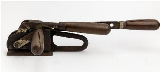
Corta raízes. Utensílio utilizado em operações farmacêuticas para promover a divisão grosseira de caules e raízes de vegetais, facilitando a moagem posterior e transformação em pó. O corta raízes é composto de uma base sobre a qual se encaixa uma alavanca com uma lâmina cortante que promove a secção dos materiais. Peça em metal e madeira, datada das primeiras décadas do século XX. Centro de Documentação e Memória RD. Foto: Adriana Moreno.
