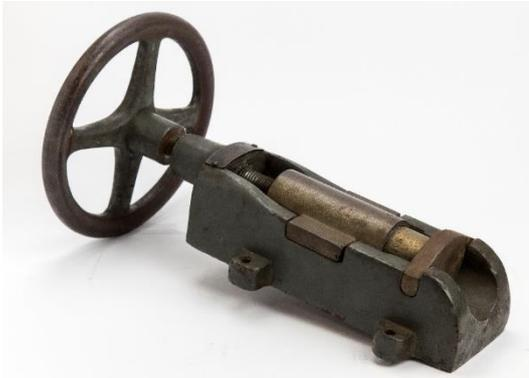
Prensa para supositórios. Utilizada para dar forma aos supositórios por extrusão. Com o uso de uma rosca sem fim, a massa do medicamento é comprimida pelos orifícios da matriz, que têm formato de torpedão. A pressão expulsa o supositório já pronto. Equipamento em ferro fundido e bronze, datado das primeiras décadas do século XX. Centro de Documentação e Memória RD. Foto: Adriana Moreno.
