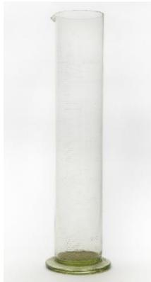
Proveta. Utensílio de vidro incolor de forma cilíndrica, utilizado nas preparações farmacêuticas para medição de volumes líquidos. Peça do tipo graduada, com escalas permitindo a medição de frações. Sem data. Centro de Documentação e Memória RD. Foto: Adriana Moreno.
