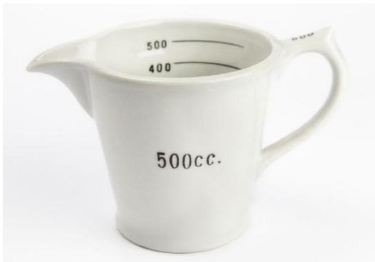
Jarra. Utilizada nas preparações farmacêuticas para medição de volumes líquidos, com curvatura tipo bico na extremidade para escoamento e alça para manuseio. Peça em porcelana com capacidade para 500 cm<sup>3</sup>, graduada para medição de volumes de frações de 100 cm<sup>3</sup>. Datada da segunda metade do século XX. Centro de Documentação Memória RD. Foto: Adriana Moreno.
