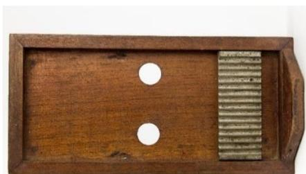
Pilulador. Utilizado na fabricação de pílulas, forma farmacêutica sólida e arredondada. A massa do medicamento com substância ativa e excipientes (substância inerte) é espalhada nos sulcos do molde e pressionada; depois é cortada e enrolada manualmente. Equipamento em madeira e bronze, datado das primeiras décadas do século
