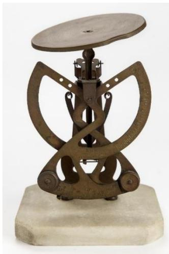
Balança. Equipamento para realizar pesagem tipo monoprato ou Columbus (menção ao fabricante), com mensuração por deslocamento de duas hastes bilaterais de contrapeso padronizado. A pesagem é fundamental em quase todos os processos farmacêuticos de fabricação de medicamentos. Balança em bronze com base em mármore, datada das primeiras décadas do século XX. Centro de Documentação e Memória RD. Foto: Adriana Moreno.
