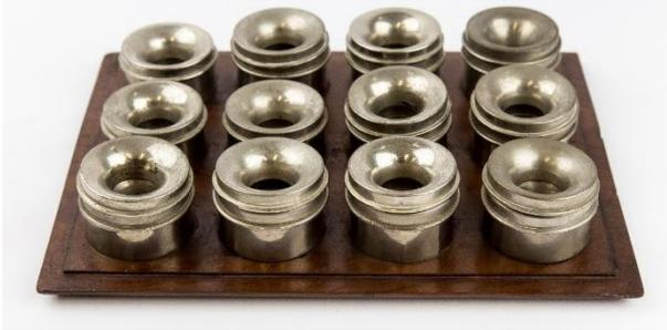
Encapsulador. Equipamento utilizado para enchimento de cápsulas tipo amiláceas (constituídas por uma base e uma tampa) com medicamentos em pó. Cada orifício metálico recebia uma base, que era então preenchida com o medicamento, fechada e selada com a tampa. Peça em madeira e metal, datada das primeiras décadas do século XX. Centro de Documentação e Memória RD. Foto: Adriana Moreno.
