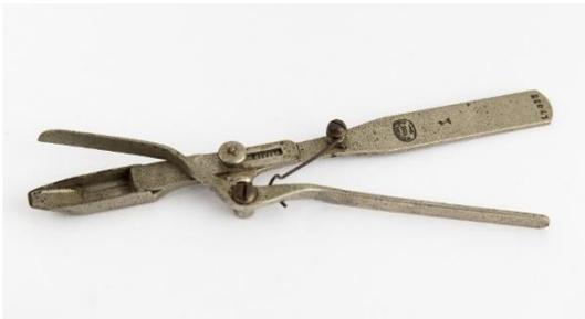
Doseador. Instrumento para medir uma determinada quantidade de medicamentos em pó, para posterior enchimento de envelopes de papel ou cápsulas amiláceas. Uma haste com um compartimento regulável é preenchida com pó, que tem sua quantidade controlada pela ação da espátula opositora. Peça datada da primeira metade do século XX. Centro de Documentação e Memória RD. Foto: Adriana Moreno.
