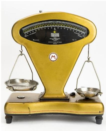
Balança granatária. Equipamento para realizar pesagem por comparação a pesos preestabelecidos, com o equilíbrio entre dois pratos, tipo granatária (em referência à sua utilização na pesagem de grãos). A pesagem é fundamental em quase todos os processos farmacêuticos de fabricação de medicamentos. Balança em metal, de origem italiana, datada de meados do século XX. Centro de Documentação e Memória RD. Foto: Adriana Moreno.
