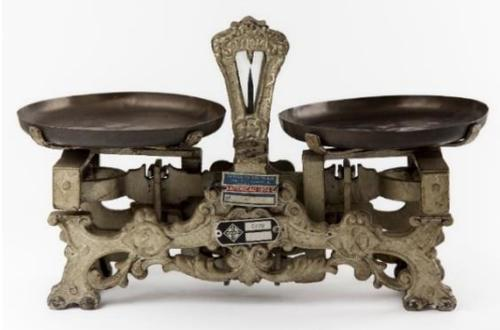
Balança Roberval. Equipamento para realizar pesagem por comparação a pesos preestabelecidos, com o equilíbrio entre dois pratos, tipo Roberval (utilizada em pesagens de quantidades maiores). A pesagem é fundamental em quase todos os processos farmacêuticos de fabricação de medicamentos. Balança em ferro e cobre, datada das primeiras décadas do século XX. Centro de Documentação e Memória RD. Foto: Adriana Moreno.
