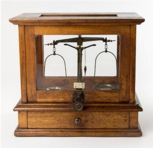
Balança de precisão. Equipamento para realizar pesagem por comparação a pesos preestabelecidos, com o equilíbrio entre dois pratos. A pesagem é fundamental em quase todos os processos farmacêuticos de fabricação de medicamentos. Balança em madeira, vidro e bronze, datada das primeiras décadas do século XX. Centro de Documentação e Memória RD. Foto: Adriana Moreno.
