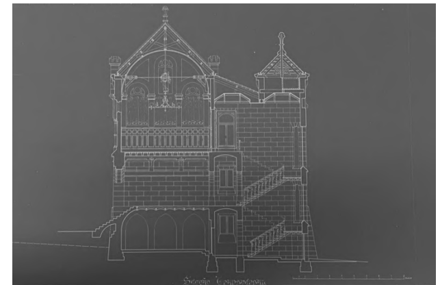
Figura 33: Abaixo e em seqüência: Elevação frontal; elevação posterior e corte transversal do edifício de Câmara e Cadeia de São Carlos (1896), respectivamente. Destaque para a estrutura de cobertura do salão do júri no corte transversal.
