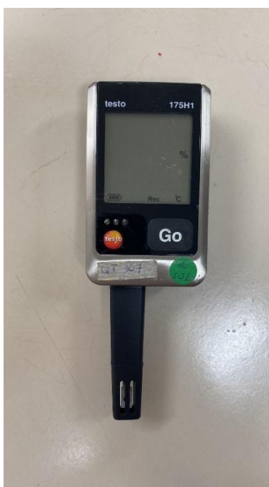
Figura 29: Medidor Digital Datalogger Testo 175H1 utilizado para a análise de dados de Temperatura interna e externa do ar
