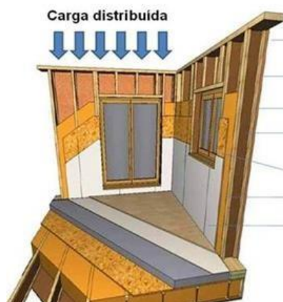
Figura 13: Componentes do Wood Frame e carga distribuída
