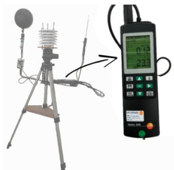
Figura 24: Equipamento multifuncional com sonda de esfera quente
