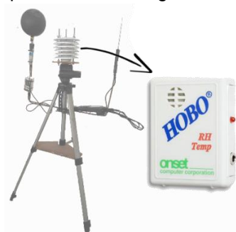
Figura 23: Equipamento termo higrômetro com datalogger
