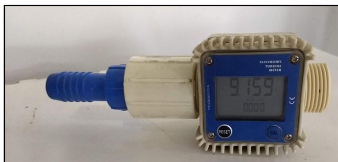
Figura 26 - Medidor de vazão d'água
