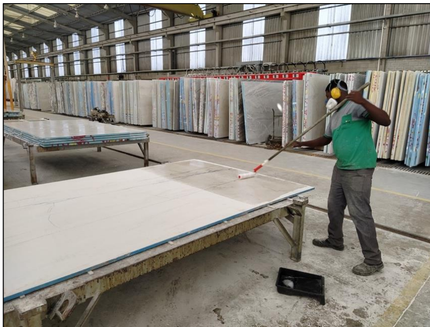
Figura 18 - Aplicação de impermeabilizantes em chapas de rochas ornamentais
