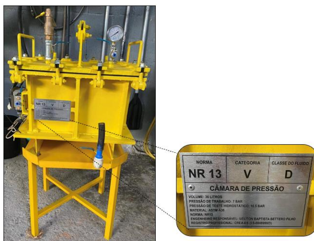
Figura 28 - Câmara de impermeabilização evidenciando suas características técnicas
