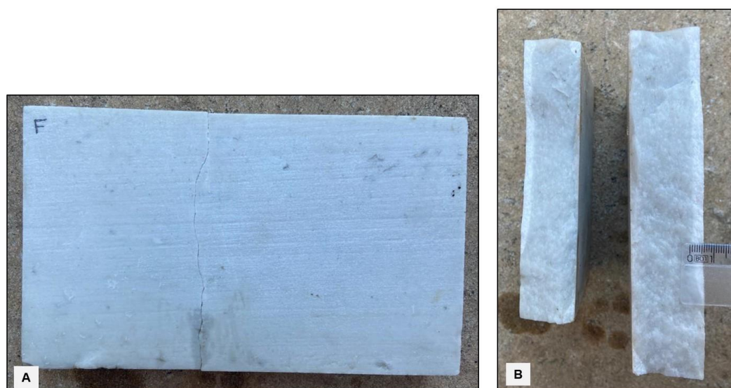
Figura 58 - A) Quartzito QZ 3 impermeabilizado sob a técnica convencional e B) amostra quebrada após 30 dias de cura
