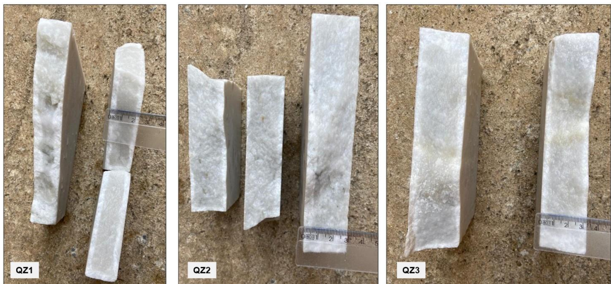
Figura 51 - Amostras quebradas após 30 dias de teste de submersão em hidrofugante durante 1 hora
