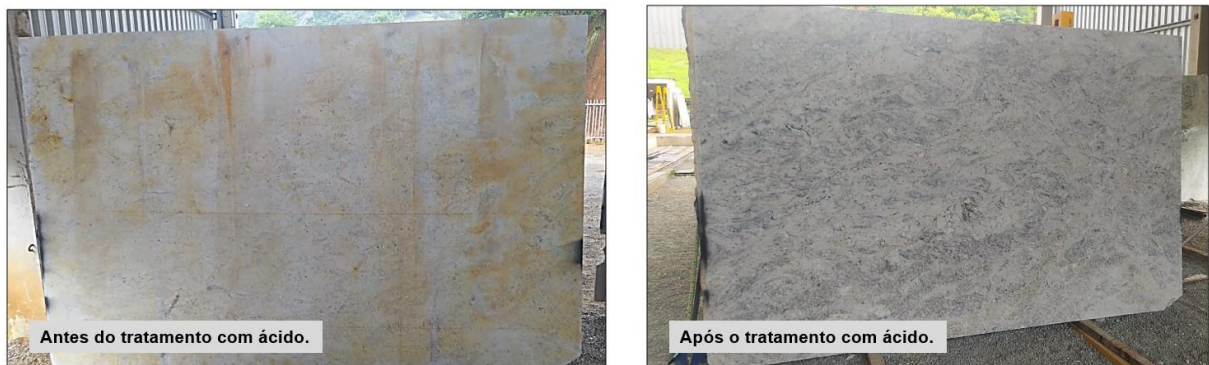
Figura 13 - Rocha com oxidação antes do tratamento com solução ácida e depois do tratamento
