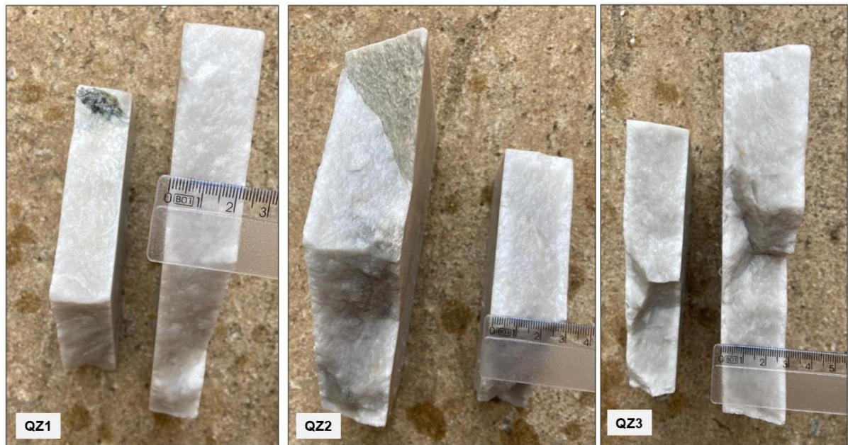
Figura 50 - Amostras dos quartzitos QZ 1 , QZ 2 e QZ 3 após 30 minutos submersos em hidrofugante
