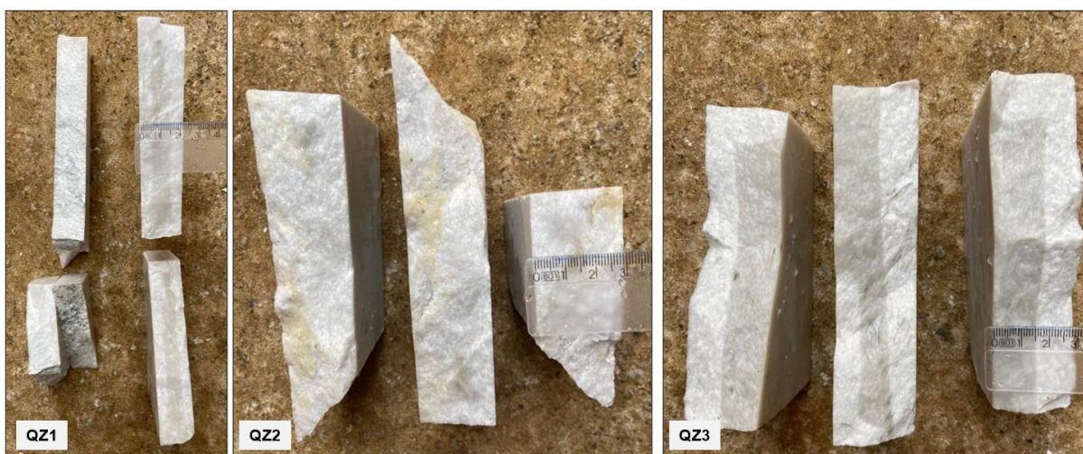
Figura 55 - Amostras quebradas após imersão em hidrofugante por 12 horas sob pressão
