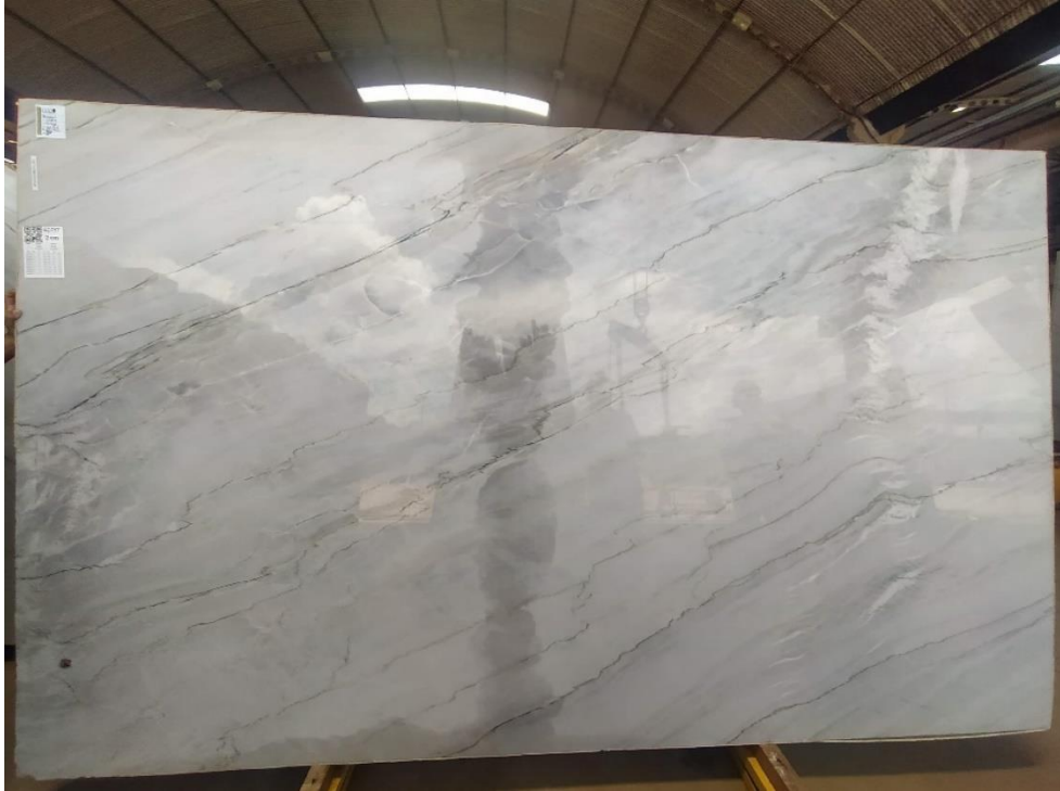
Figura 16 - Chapa de quartzito branco apresentando mancha por absorção de água na parte central
