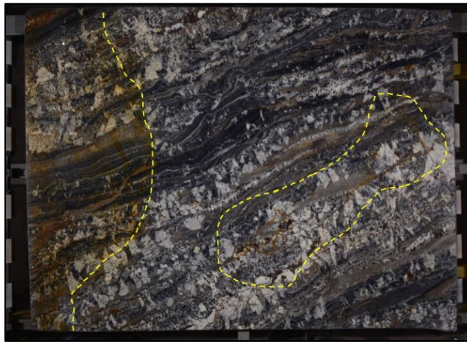
Figura 12 - Chapa de rocha ornamental com manchas de oxidações em destaque
