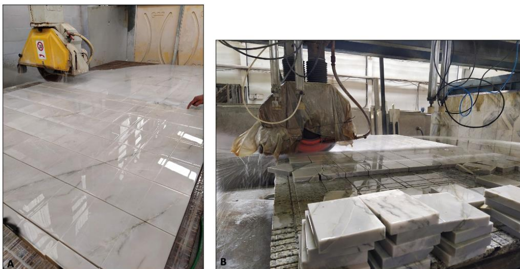
Figura 34 - (A) Corte de chapa de quartzito e (B) corte de chapa para obtenção das amostras
