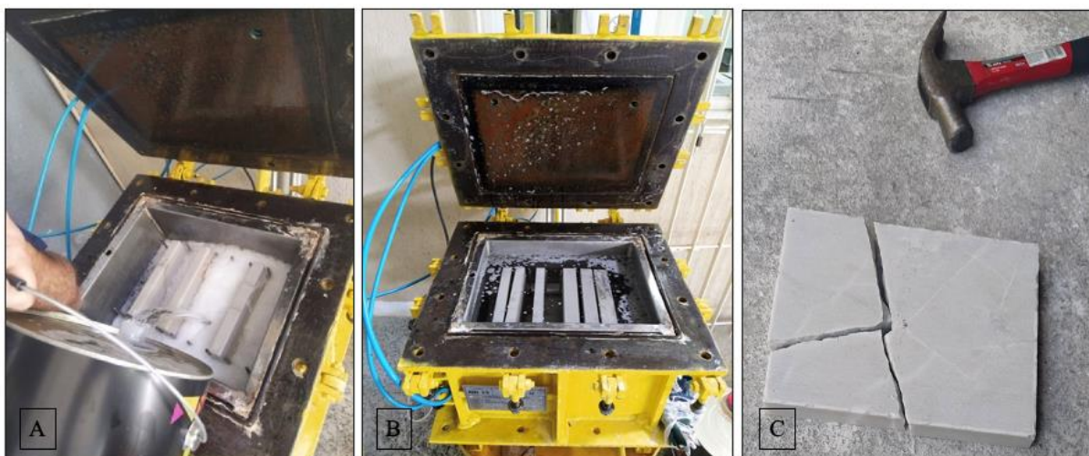
Figura 36 - (A) Adição do impermeabilizante na câmara, (B) amostras submersas antes da aplicação do vácuo e (C) quebra da amostra após a cura para verificar a penetrabilidade do impermeabilizante
