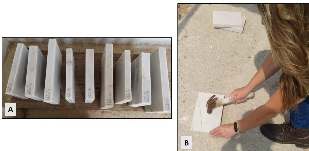
Figura 39 - A) Amostras curando após imersão na câmara e B) quebra das amostras após a cura
