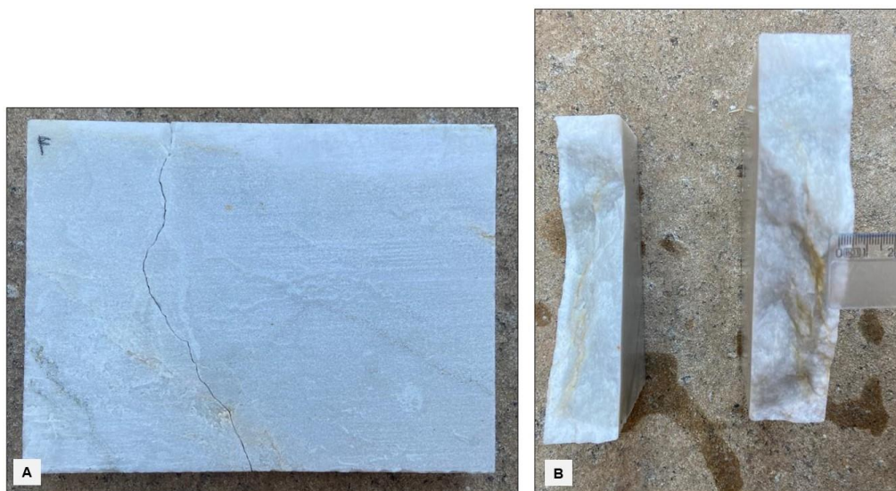
Figura 56 - A) Quartzito QZ 1 impermeabilizado sob a técnica convencional e B) amostra quebrada após 30 dias de cura
