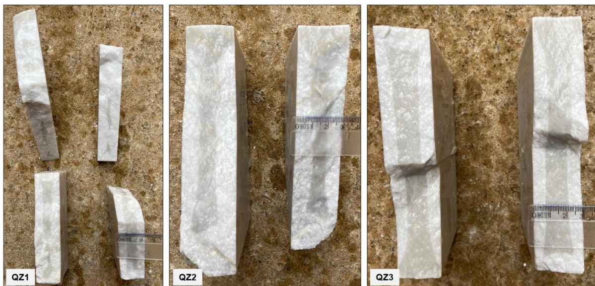
Figura 54 - Amostras quebradas após imersão em hidrofugante por 6 horas sob pressão
